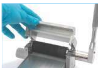
Для смены рола-лезвия необходимо поднять верхнюю прижимную часть
